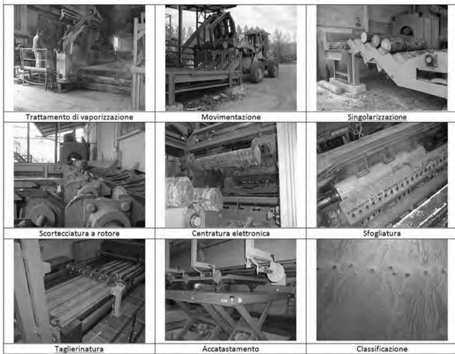
Fig. 3 Fasi del processo di sfogliatura dei topi di douglasia
