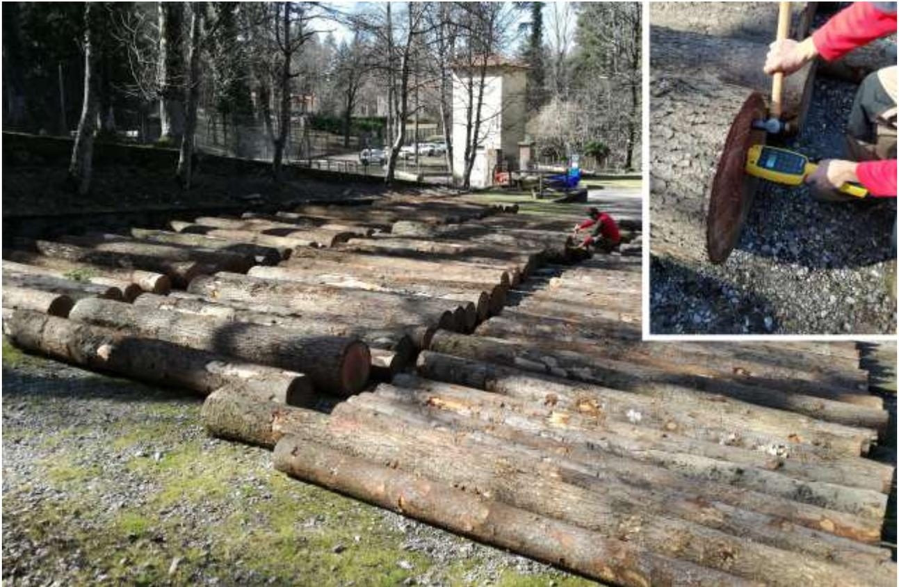
Figura 1 – Misurazioni strumentali su topo in piazzale
